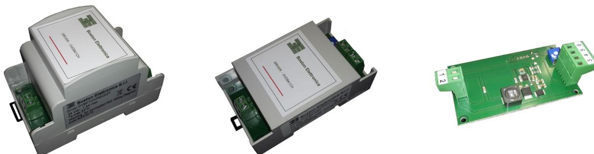
**Driver MONOCANALE a corrente costante per alimentazione illuminatori a power e middle power led**
